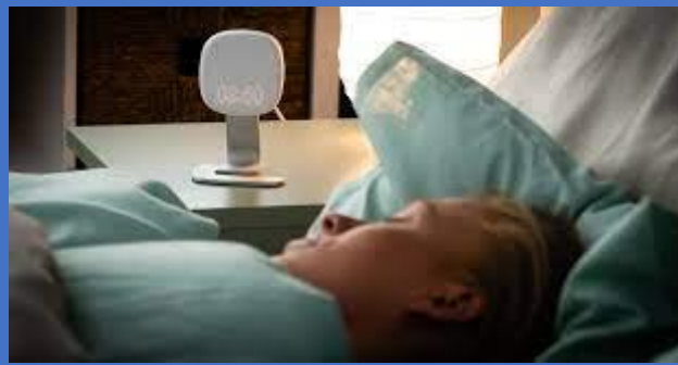
PLASSERING AV RADARSENSOR
